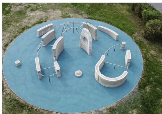
EPDM je polopropustným materiálem, na výrobu ekologicky náročný, lze jej však zhotovit z recyklátu
